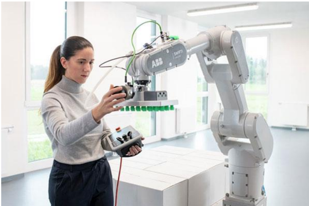
โคบอทส์ของ ABB ที่รองรับน้ำหนักได้มากกว่ารุ่นก่อนถึง 6 เท่า แต่มีความเร็วต่ำกว่าหุ่นยนต์อุตสาหกรรมเพื่อความปลอดภัยของวิศวกร Image credit: Nikkan
